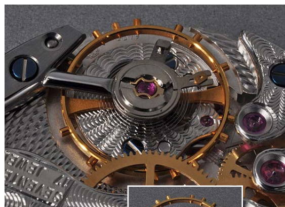
Schraubenunruh mit Spiralfeder
