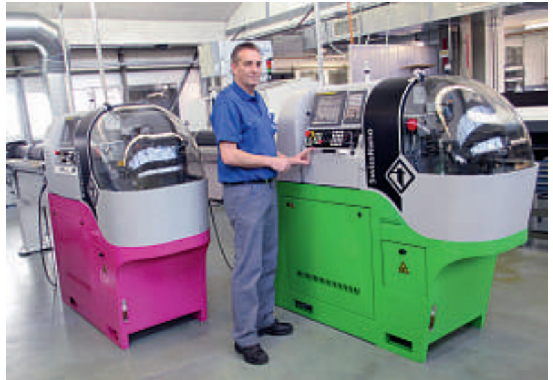
Produktionsleiter Markus Gnägi schätzt die farbenfrohen, kompakten SwissNanos, mit denen sich Werkstücke bis 28 mm Länge und 4 mm Durchmesser fertigen lassen.
