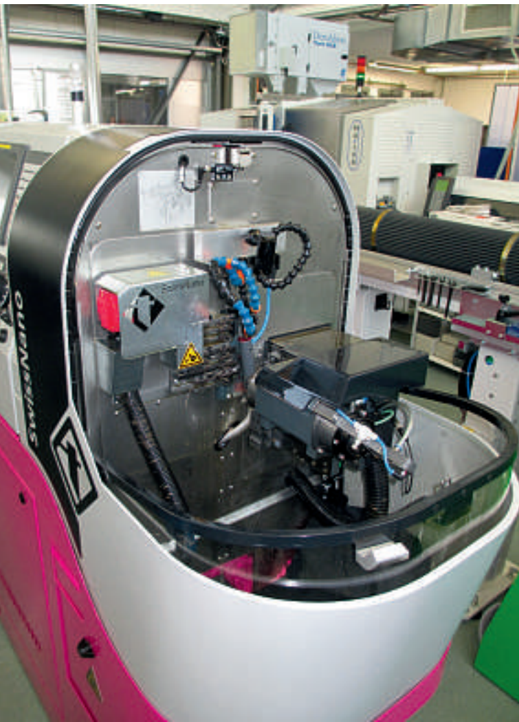
Blick in den Arbeitsraum des Drehautomaten SwissNano von Tornos bei abgesenkter Schutzhaube. (Bilder: TR)
