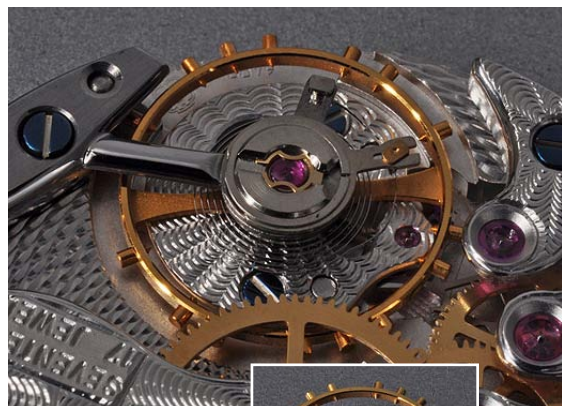
Schraubenunruh mit Spiralfeder
