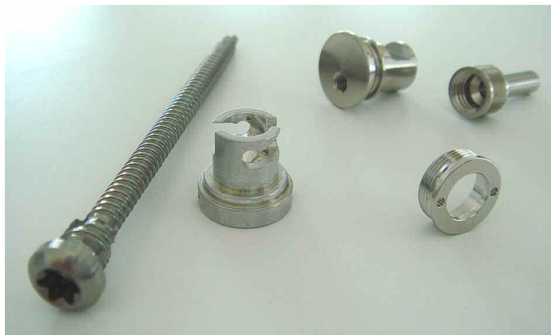
Einige neuere Teilebeispiele gefertigt auf unseren DECO 2000/13: Eine Knochenschraube aus Titan mit doppelgängigem mehrstufig gewirbeltem Gewinde mit Selbstschnitt und Innensechsrund-Antrieb (Torx), ein Alu-Drehteil mit Bajonett-Fräsung, drei verschiedene Drehteile aus rostbeständigem Chromstahl, mit genauen Passungen und Fräsungen, teilweise gefertigt mit Hochfrequenzspindeln.
